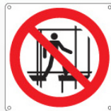
Vietato l'uso di questa impalcatura incompleta P025 ●
